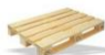
Europalette nach DIN 15146 (Vierwegepalette) Abmessung: 1200 x 800 x 144 mm Tragfähigkeit: 1000 kg Eigengewicht: 25 kg
